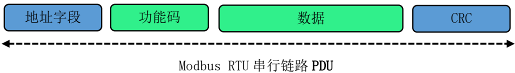
图 12 串行链路上的 Modbus 帧
